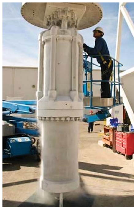
FIG. 1 Nine-stage submersible LNG sendout pump, post-performance test.
